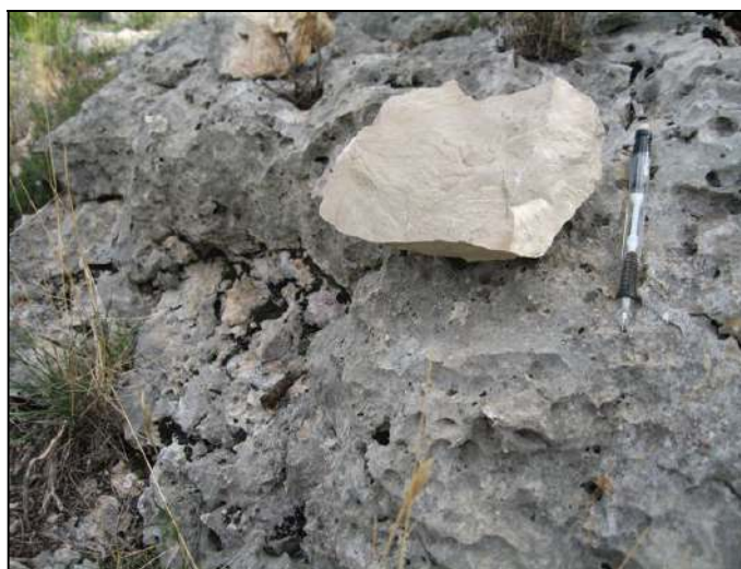
Fractura concoidea y aspecto en superficie de las calizas.
